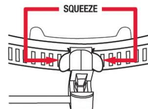
Presser sur les languettes de la navette et faites la glisser le long du guide jusqu'à positionner le système de fixation au dessus de la sonde.
